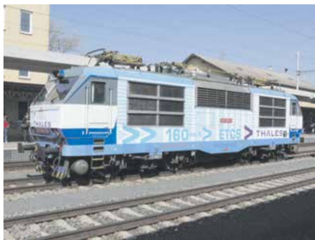
Слика 4: Локомотива ŠKODA HDV 350 са „Thales“-овим уређајем ETCS
