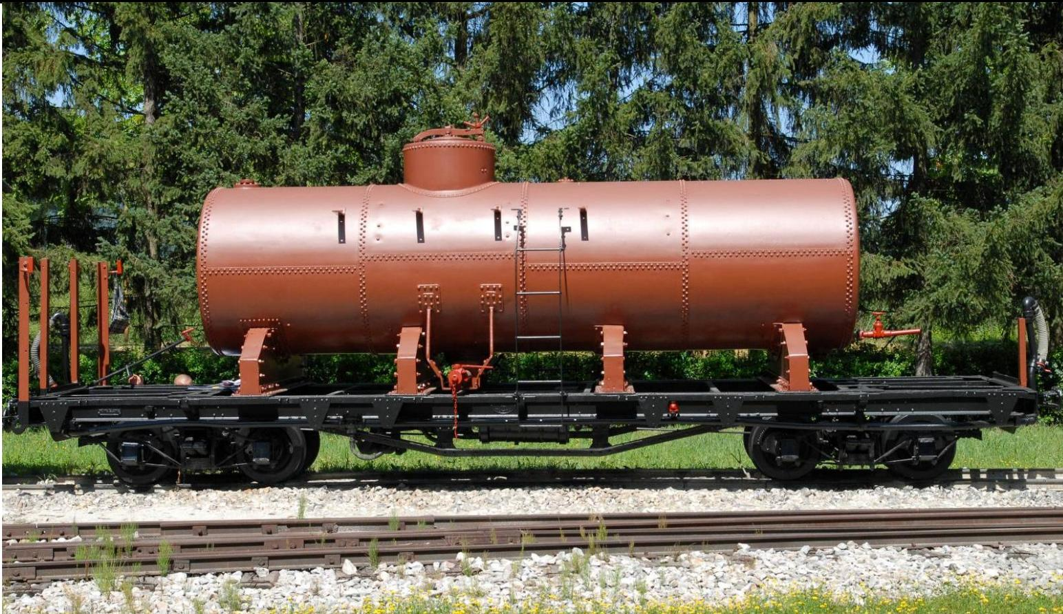
Četvoroosovinska kazanska kola serije R 84702, saobraćala su na svim uzanim prugama i, na kraju, na pruzi Paraćin-Zaječar. Reč je o kolima sa RUČNOM VAZDUŠNOM KOČNICOM, sopstvene težine 9470kg, tovarne težine 15 000kg, dugim 9000mm, širokim 2400mm i visokim 3000mm.
